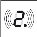
Schnelles Blinken in der 7-Segment-Anzeige
